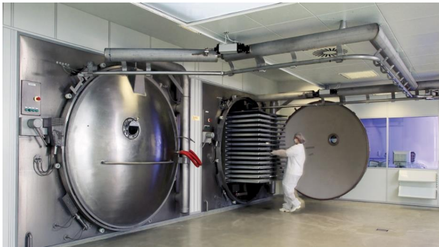
Mynd 12. Tveir Ray frostþurrkarar ásamt flutningskerfi. Mynd, www.gea.com .
